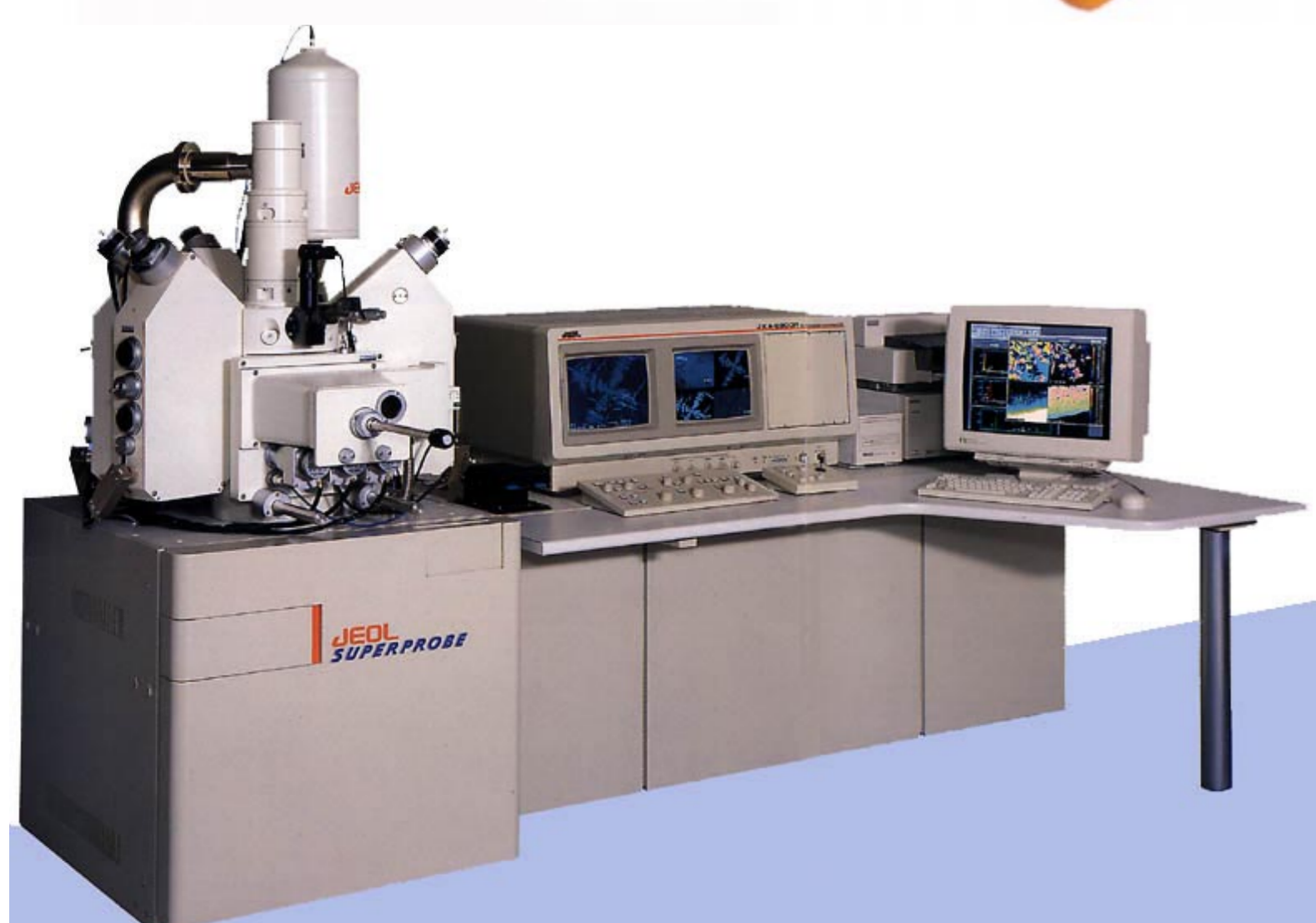
Abbildung 5.1: a) schematischer Aufbau der Elektronenstrahlmikrosonde b) Ansicht der neuen JEOL JXA-8900 RL des Instituts für Mineralogie und Geochemie der Universität zu Köln
