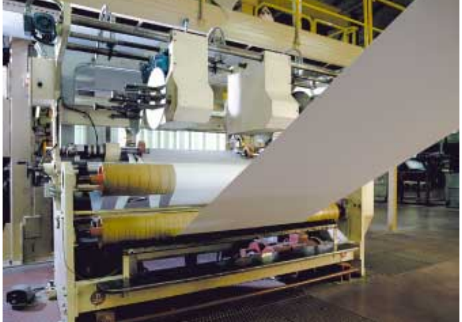
Kalandrierwerk zur Herstellung von PVC-Folie
