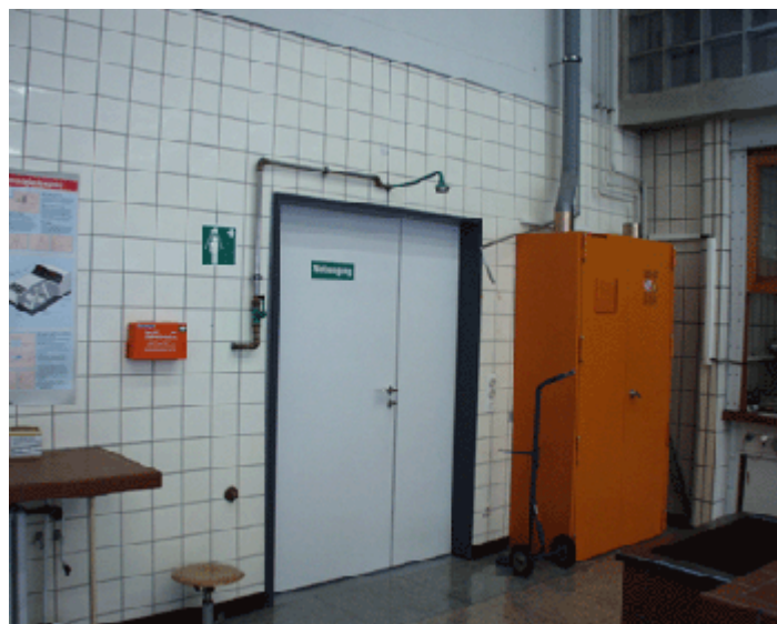
Abbildung 2: Bei einem Unfall mit Chemikalien geeignete Maßnahmen einleiten. Über jeder Tür befindet sich eine Notdusche. Zur Sicherheit werden Gasflaschen in einem Stahlschrank aufbewahrt. Auf den Tischen ist die Verwendung offener Flamme nicht erlaubt, sondern nur unter besonders gekennzeichnetem Abzug.
