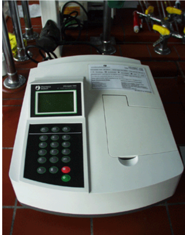
Abbildung 1–4: Das im Praktikum verwendete ULTROSPEC1000 ist ein einfach zu bedienendes Spektralphotometer, das Sie zur Messung der Absorption von Lösungen bei von Ihnen vorgewählten Wellenlängen verwenden.
