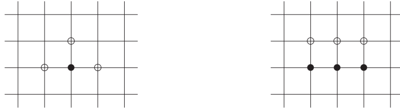
Abbildung 11.9: Diskretisierungsschema des impliziten Eulerverfahrens (links) und des Trapezverfahrens (rechts). Symbole wie in Abb. 11.3.2
